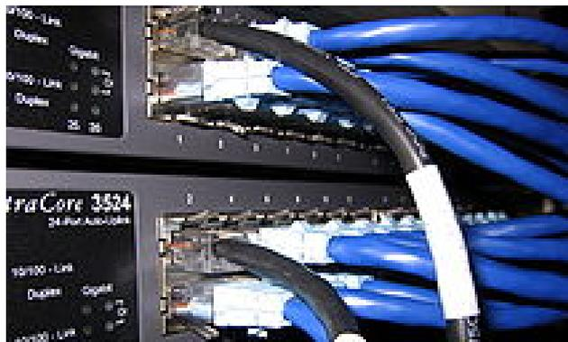
Conexiones en un switch Ethernet
