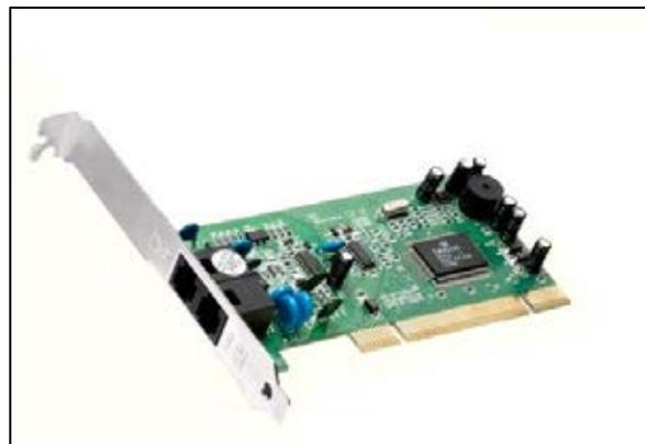
Al proceso por el cual obtenemos una señal analógica a partir de unos datos digitales se le denomina **modulación**. Esta señal la transmitimos y el receptor debe realizar el proceso contrario, denominado **demodulación** para recuperar la información. El módem es el encargado de realizar dicho proceso. Algunos esquemas simples de modulación son:
