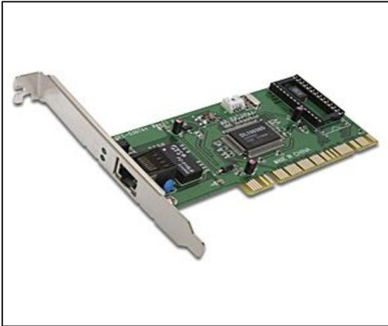
Una **tarjeta de interfaz de red** o Network Interface Card (**NIC**) (también conocida como *adaptadora* o *tarjeta adaptadora*) es una placa de circuito instalada en un componente de equipo de informática, como un PC, por ejemplo, que *le permite conectar el ordenador a una red mediante una línea digital*.
