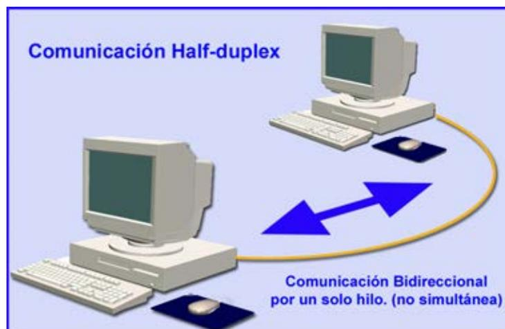
En los diseños de redes de información, conectadas con cable coaxial en banda base, también se produce este tipo de comunicación: mientras una estación transmite no puede recibir, y si le llegara un paquete de información desde otro puesto, éste **colisionaría** con el recién enviado, y se perderían ambos.
