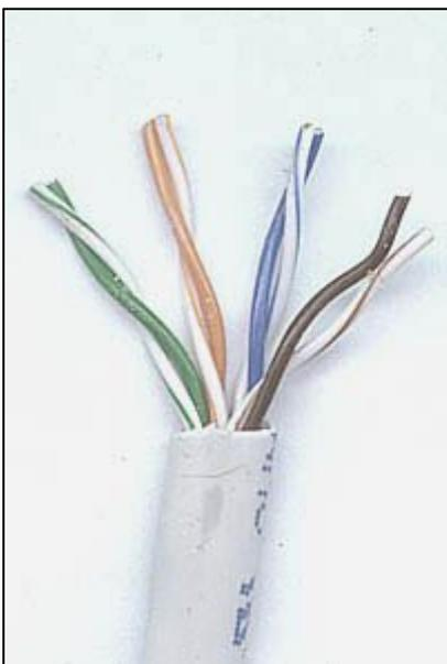
Es de los más utilizados del mercado y el más popular: consiste en dos alambres de cobre o a veces de aluminio, aislados con un grosor de **1 mm** aproximado. Los alambres se trenzan con el propósito de reducir la interferencia eléctrica de pares similares cercanos. Los pares trenzados se agrupan bajo una cubierta común de PVC (Policloruro de Vinilo) en cables multipares de pares trenzados (de 2, 4, 8...hasta varios centenares de pares).
