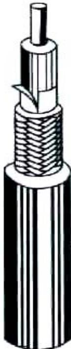
Se usa normalmente en la conexión de redes con topología de Bus como Ethernet y ArcNet, es llamado así porque su construcción es de forma coaxial; tenemos el conductor central, un recubrimiento dieléctrico, una malla de alambre y un recubrimiento externo que tiene una doble función: como recubrimiento de protección y como aislante.
